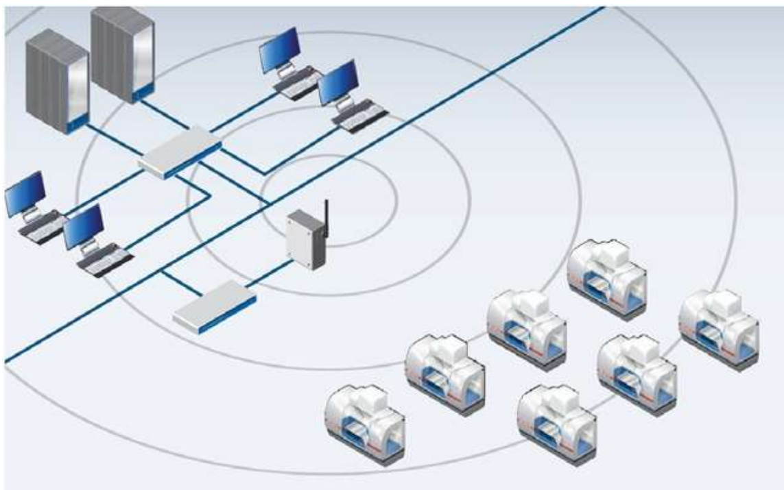
Obrázek č. 7 – DNC schéma
