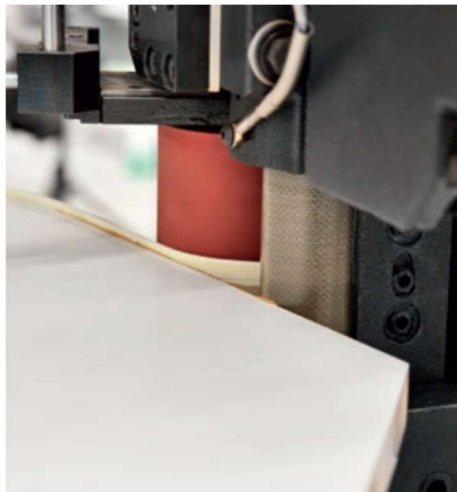
Obrázek č. 31 – Detail olepovací jednotky s přítlačným válečkem
