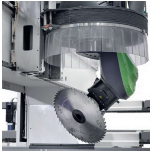
Obrázek č. 32 – Frézovací jednotka s pilovým kotoučem
