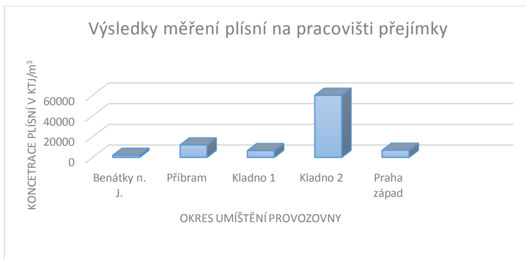
Obrázek 17: Graf porovnání výsledků měření na pracovišti přejímky odpadů a nahrnování na pás (zdroj autor)
