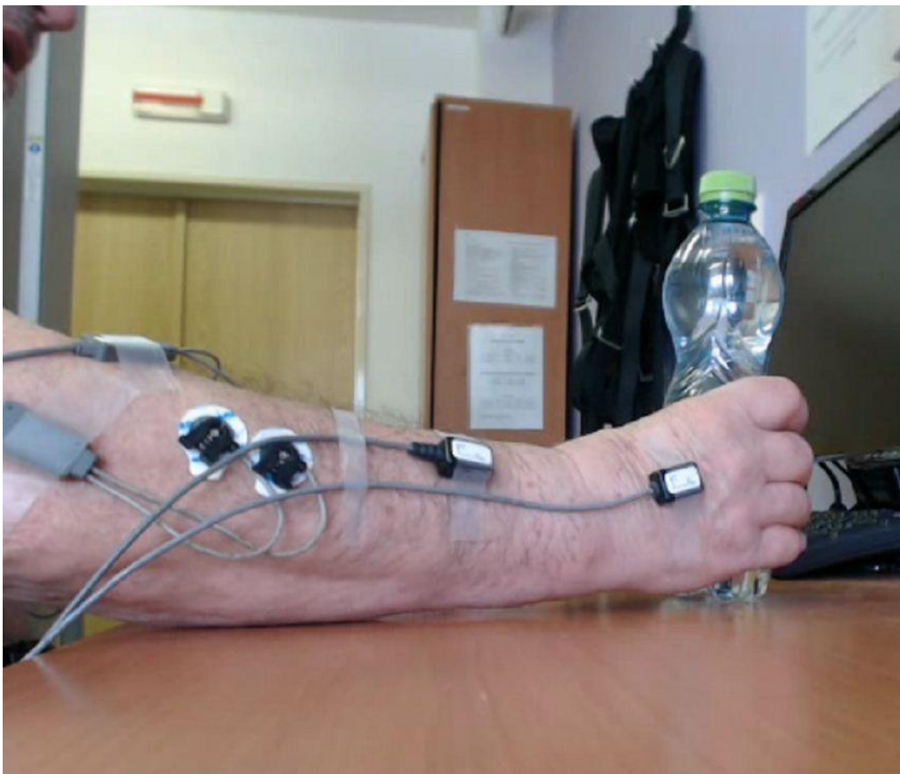
Obrázek 4 Umístění akcelerometrů na ruce a předloktí
