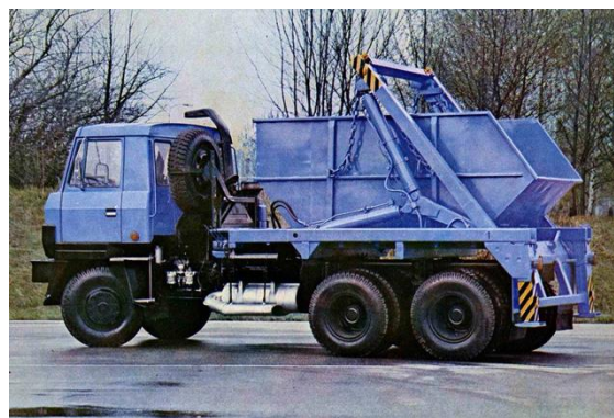
Obrázek č. 9: Ukázka řetězového nosiče kontejneru (Czechmat, 2022)
