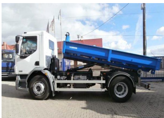
Obrázek č. 8: Ukázka hákového nosiče kontejneru (Inzerce, 2022)
