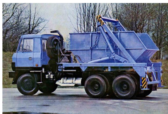
Obrázek č. 9: Ukázka řetězového nosiče kontejneru (Czechmat, 2022)
