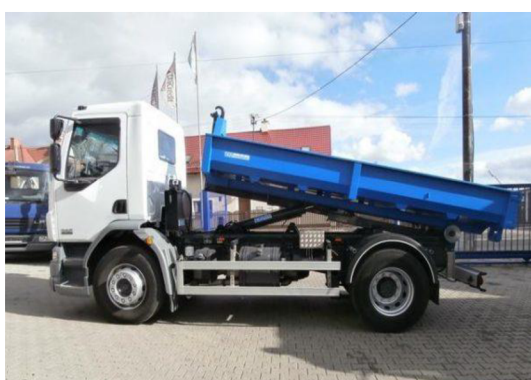
Obrázek č. 8: Ukázka hákového nosiče kontejneru (Inzerce, 2022)
