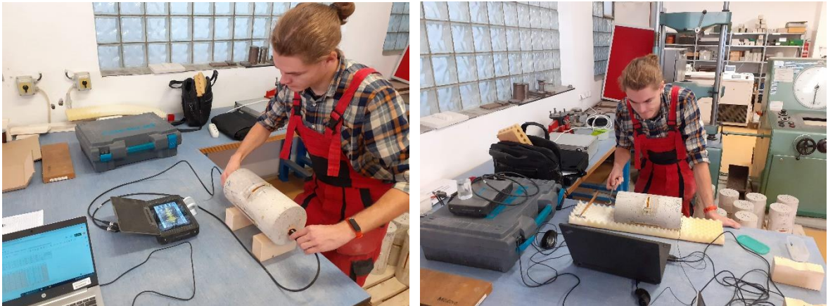
Obr. 27: Měření doby průchodu UZ impulsu (vlevo), stanovení vlastní frekvence zkušebního tělesa (vpravo) [fotoarchiv Ing. Dalibora Kocába, Ph.D.]
