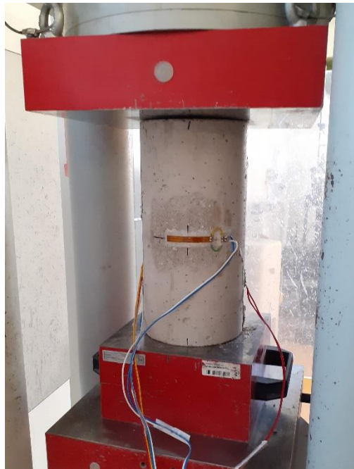
Obr. 26: Stanovení pevnosti zatěžovací zkouškou v hydraulickém lisu
