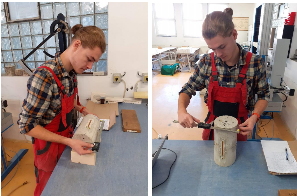
Obr. 25: Měření rozměrů zkušebních těles [fotoarchiv Ing. Dalibora Kocába, Ph.D]
