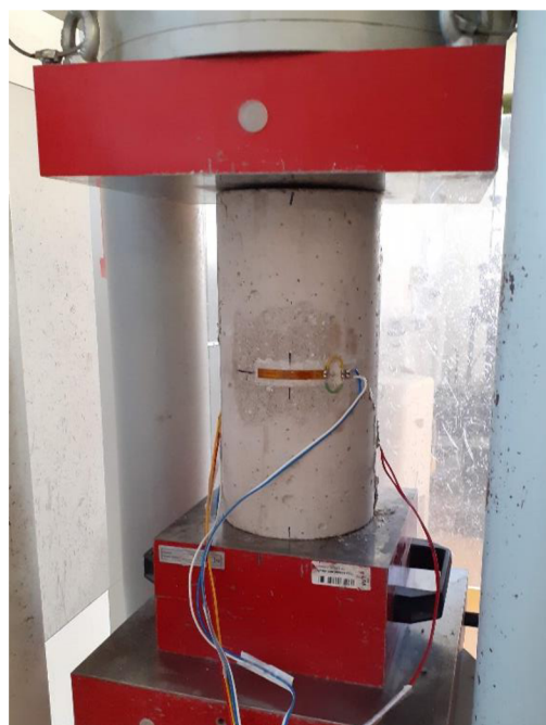
Obr. 26: Stanovení pevnosti zatěžovací zkouškou v hydraulickém lisu
