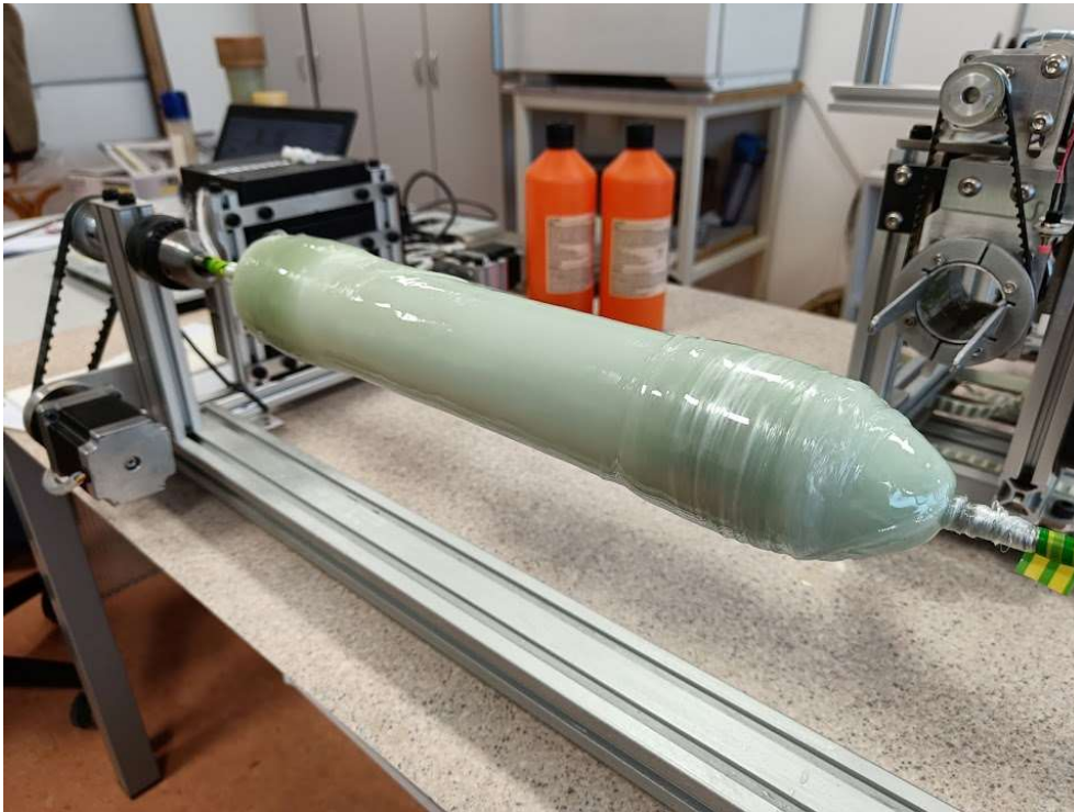
Obr. 4.33 Konečná konstrukce vložky výměníku po navíjecím procesu.
