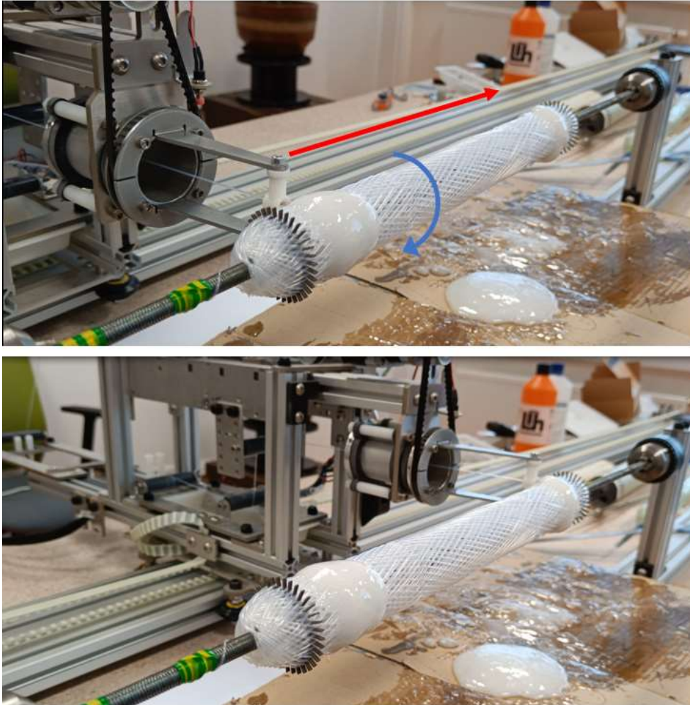
Obr. 4.19 Druhý pohyb navíjecího zařízení v průběhu navíjení vložky výměníku.
