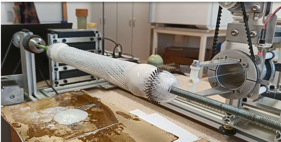
Obr. 4.20 Třetí pohyb navijecího zařízení v průběhu navíjení vložky výměníku.
