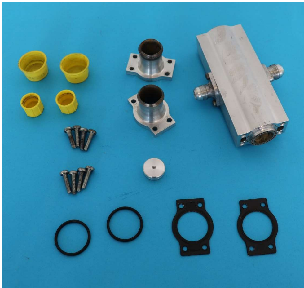
Obr. 4.11 Hlavní komponenty olejového chladiče pro závodní automobil.
