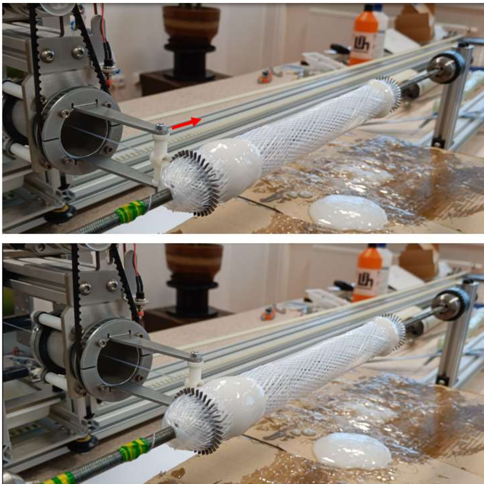
Obr. 4.18 První pohyb navijecího zařízení v průběhu navíjení vložky výměníku.
