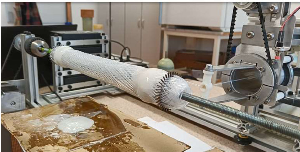
Obr. 4.20 Třetí pohyb navijecího zařízení v průběhu navijení vložky výměníku.
