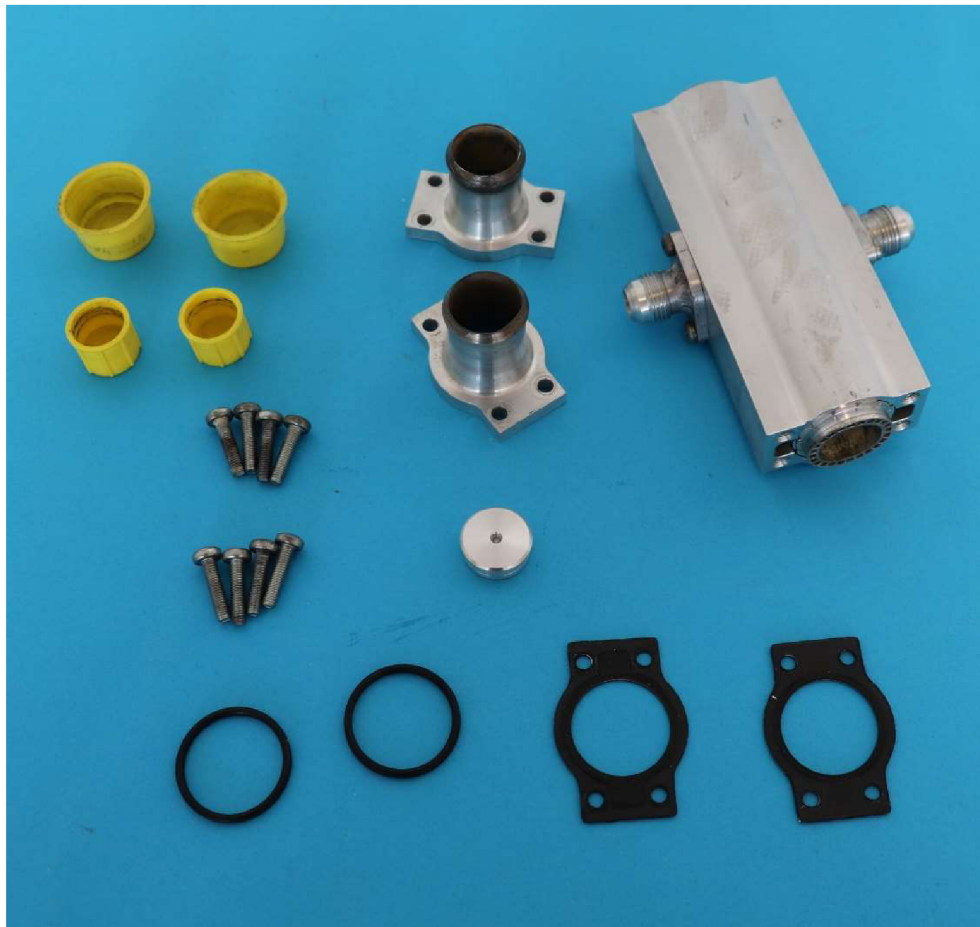
Obr. 4.11 Hlavní komponenty olejového chladiče pro závodní automobil.
