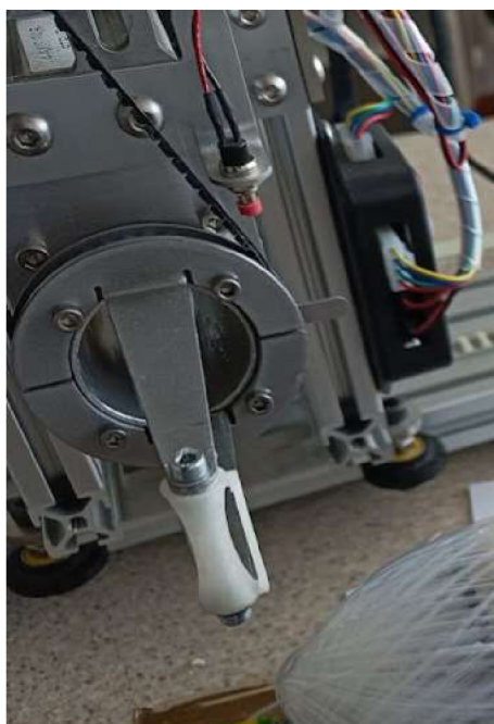
Obr. 4.6 Navijecí hlava určená pro navijení skleněného vlákna.
