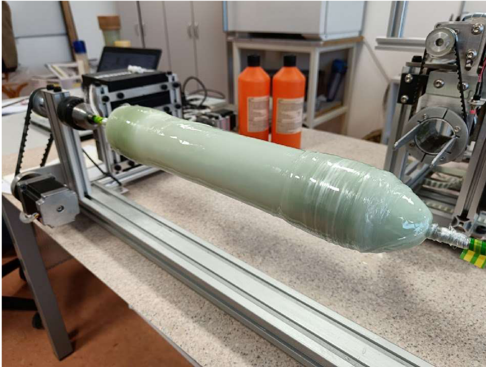
Obr. 4.33 Konečná konstrukce vložky výměníku po navíjecím procesu.
