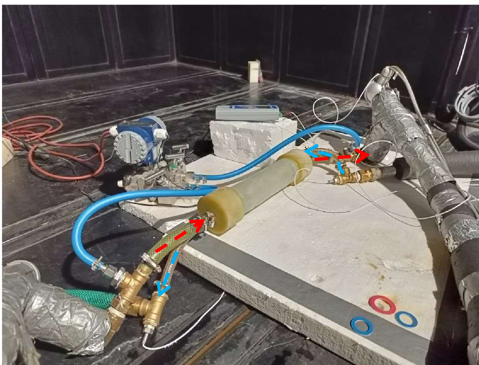
Obr. 4.40 Zapojení navrženého olejového chladiče v komoře.
