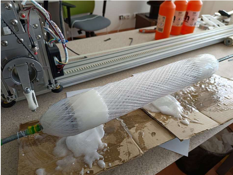
Obr. 4.30 Konečná struktura dutých vláken ve vložce výměníku.
