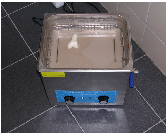
Obr. 3.14 Odstranění podpor modelu pomocí ultrazvukové čističky P702.
