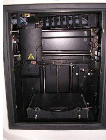
Obr. 3.9 Vnitřní prostor 3D tiskárny uPrint.
