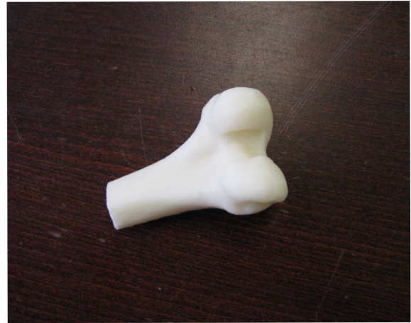
Obr. 3.15 Model kosti kolenního kloubu po odstranění podpor.
