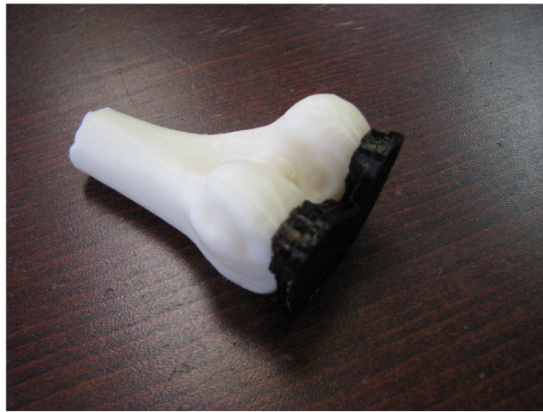
Obr. 3.13 Model kosti kolenního kloubu s podporou.
