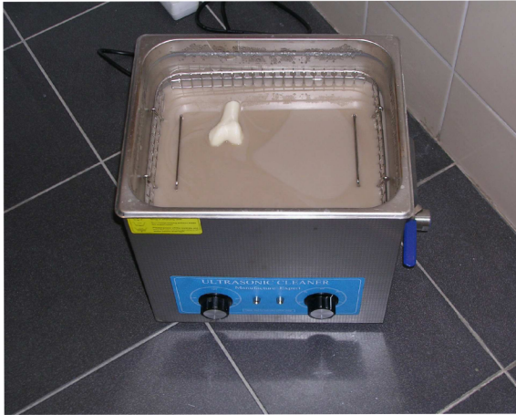
Obr. 3.14 Odstranění podpor modelu pomocí ultrazvukové čističky P702.
