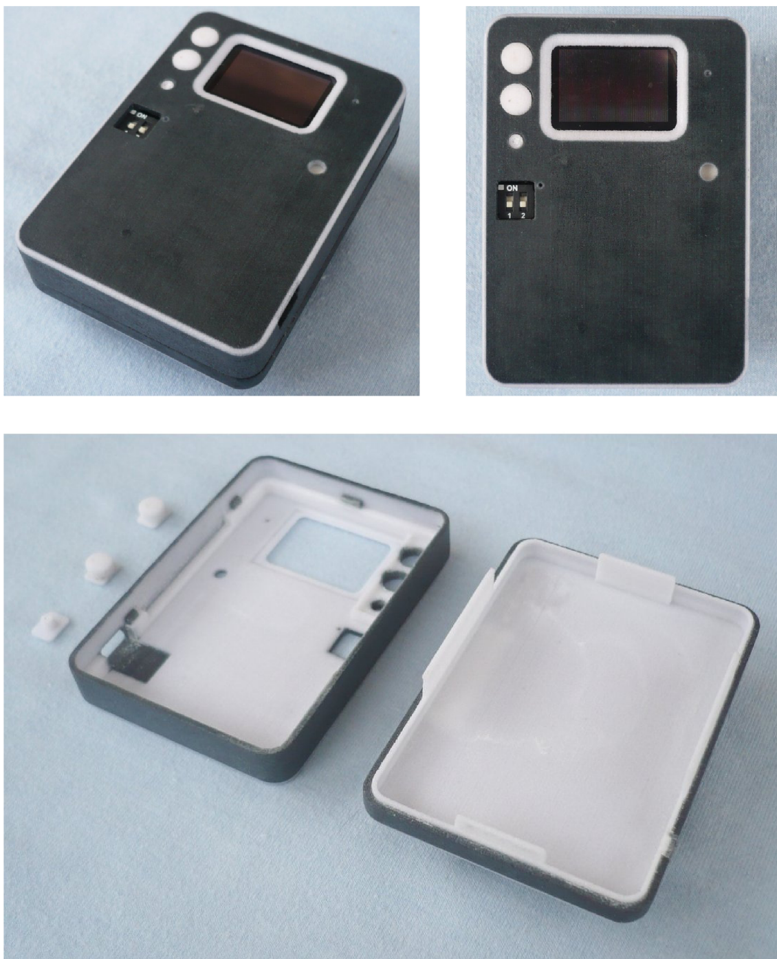
Obr. 6.3: Prototyp měřiče v obalu zhotoveném na 3D tiskárně
