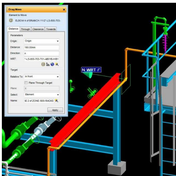
Obr. 3-28 Nastavena vzdálenost 150 mm od profilu konstrukce
