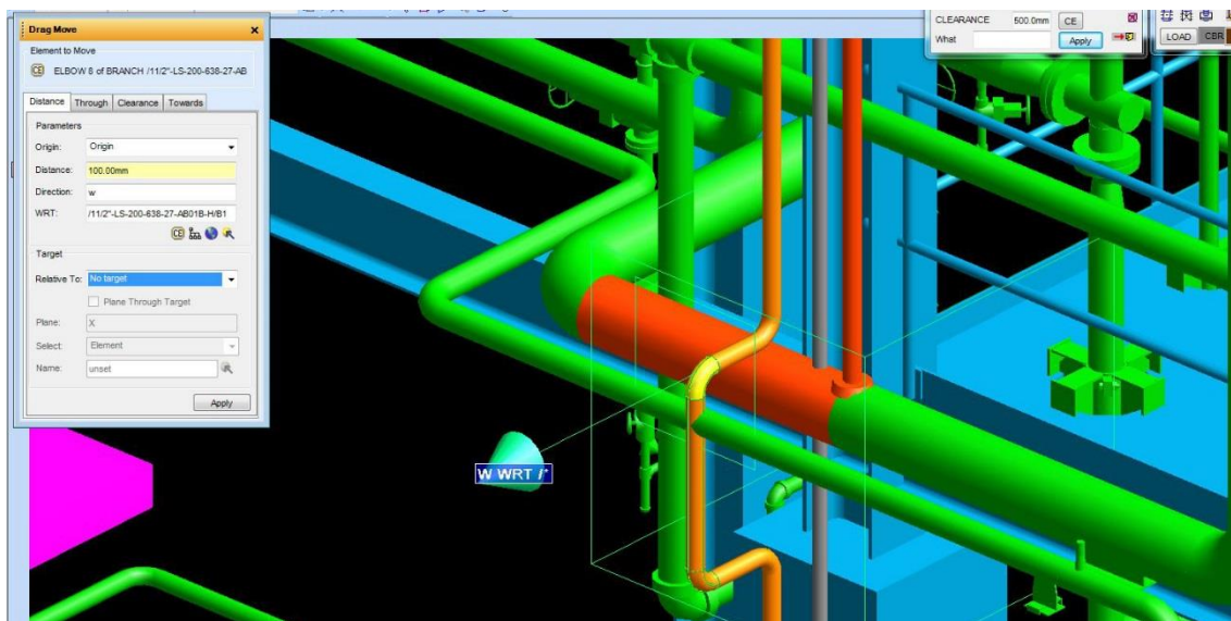
Obr. 4-14 Posunutí potrubí ve směru W
