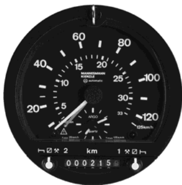
Obrázek č. 5: Kulatý otevírací EC tachograf KIENZLE typ 1318
