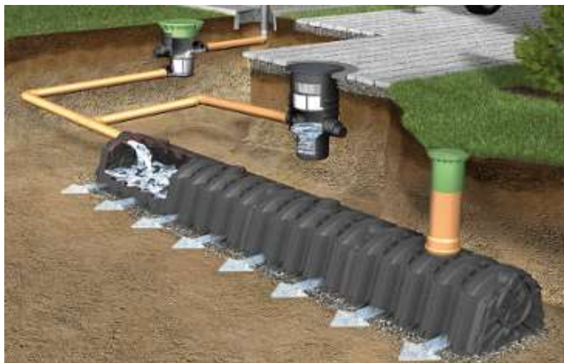
Obr. 13. Tunelové vsakovací zařízení [Obr. 13]
