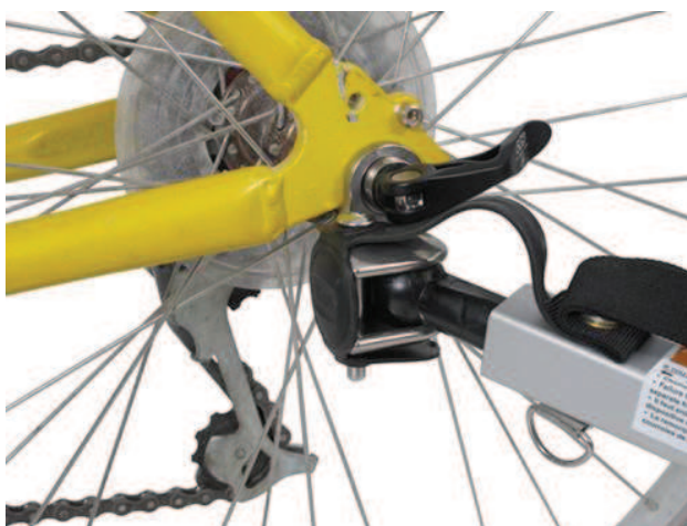
Obr. 8 Díl uchycení k jízdnímu kolu [5]
