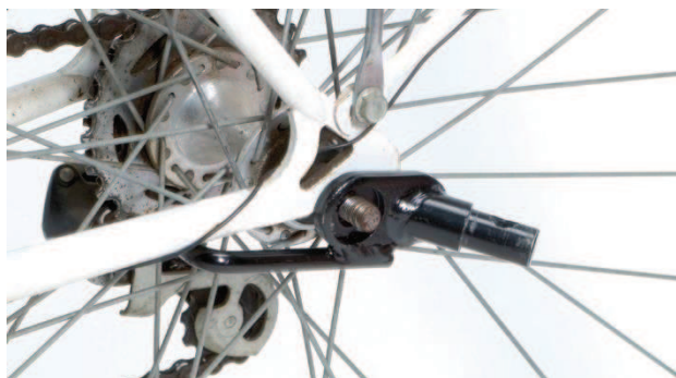
Obr. 38 Čep, sloužící k připojení vozíku [21]
