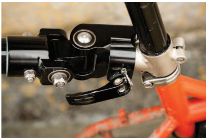
Obr. 27 Mechanismus uchycení vozíku k jízdnímu kolu [16]
