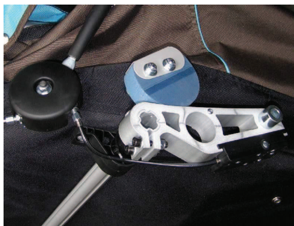
Obr. 6 Odpružení vozíku Croozer Kid plus [3]
