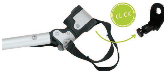
Obr. 2 Mechanismus uchycení k jízdnímu kolu [1]
