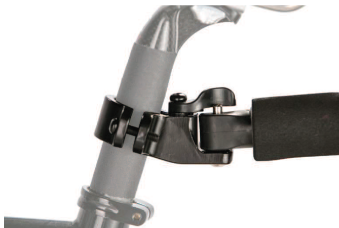
Obr. 22 Mechanismus uchycení ke kolu [13]
