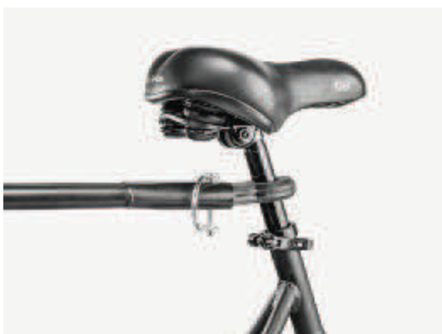
Obr. 25 Připojení vozíku k jízdnímu kolu [14]
