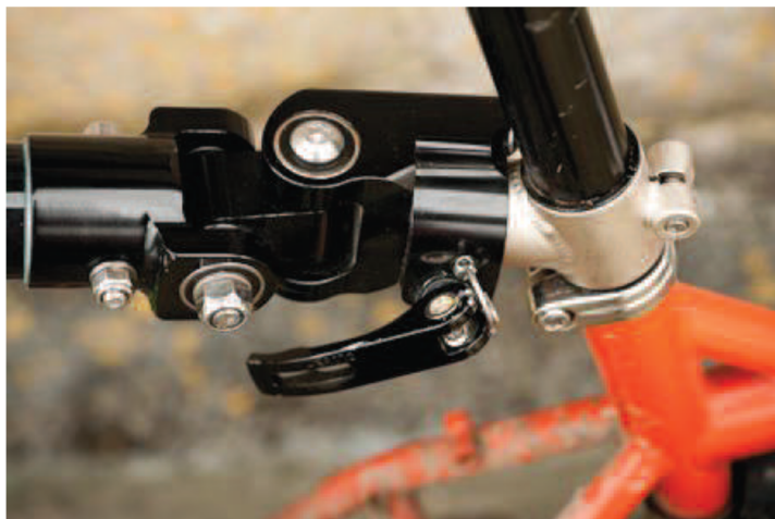
Obr. 27 Mechanismus uchycení vozíku k jízdnímu kolu [16]
