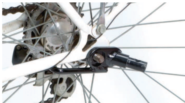
Obr. 38 Čep, sloužící k připojení vozíku [21]
