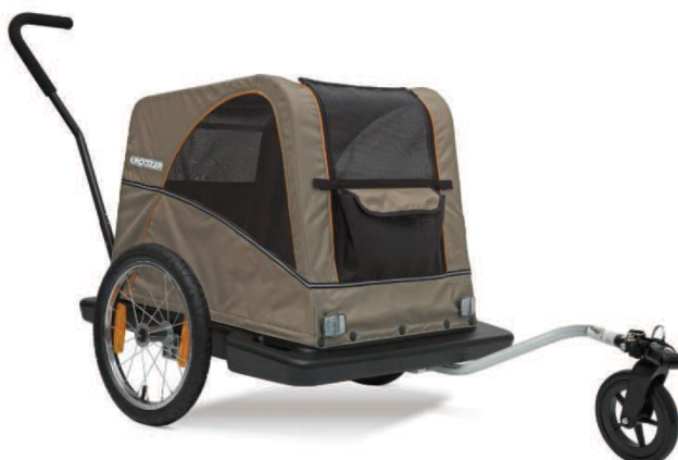
Obr. 32 Přestavba na ruční vozík [19]
