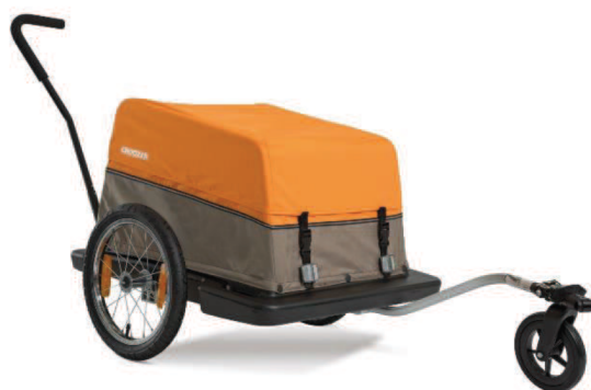
Obr. 18 Přestavba na ruční vozík [11]
