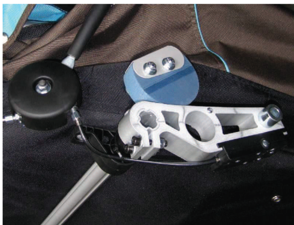
Obr. 6 Odpružení vozíku Croozer Kid plus [3]
