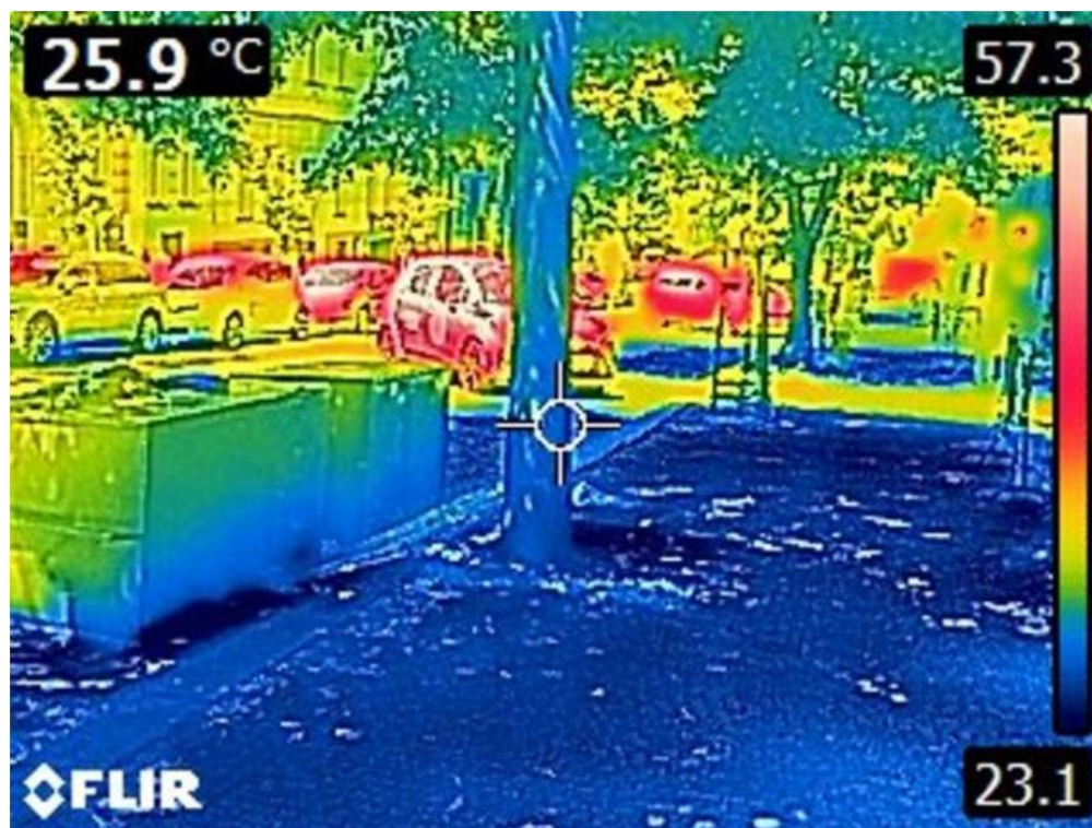
Obrázek 14: Využití termokamery k analýze teploty uličního prostoru (URL14)
