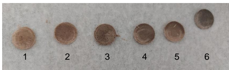
Obr. 32 Tableta modifikovaného lignínu pre meranie FTIR (1... 1 mg CLEA imobilizátu; 2... 1,5 mg CLEA imobilizátu; 3... 2,5 CLEA imobilizátu; 4... 3 krúžky imobilizátu BC; 5... 6 krúžkov imobilizátu BC; 6... 3 krúžky dezintegrovaného imobilizátu BC).
