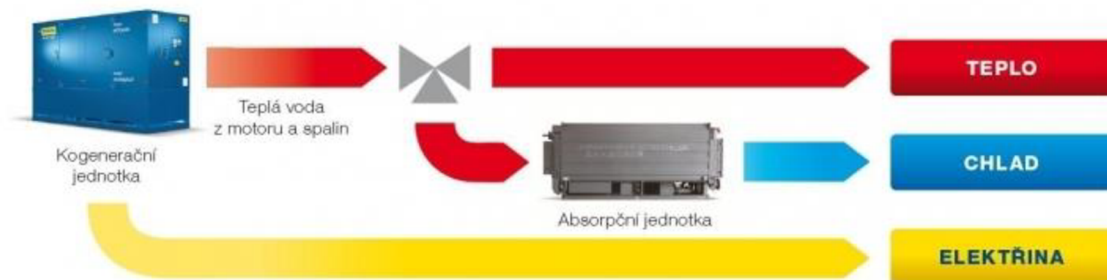
Obr. A 11: Třigenerační jednotka s absorpční jednotkou – typ A
