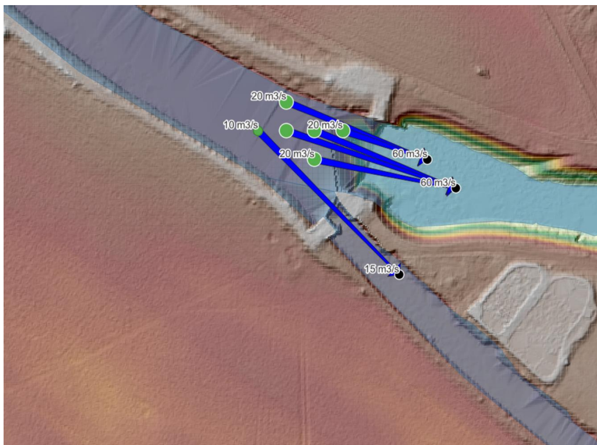
Obr. 13 - Schematizace využití funkce Virtual Pipes pro jez v Litvli
