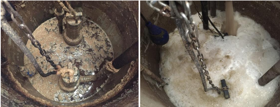
Obr. 24 Poloprovozní AnMBR - znečišťování egalizační nádrže a pění obsahu (foto autor)
