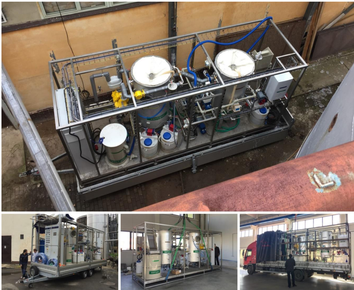
Obr. 20 Poloprovozní AnMBR jednotka (foto autor)
