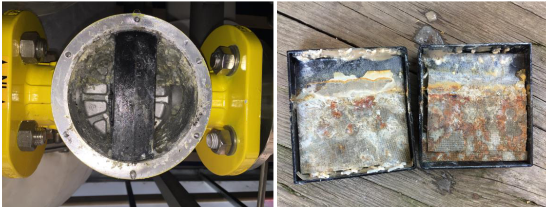
Obr. 30 Poloprovozní AnMBR - čištění a přetěsnění filtru dmychadla bioplynu (foto autor)
