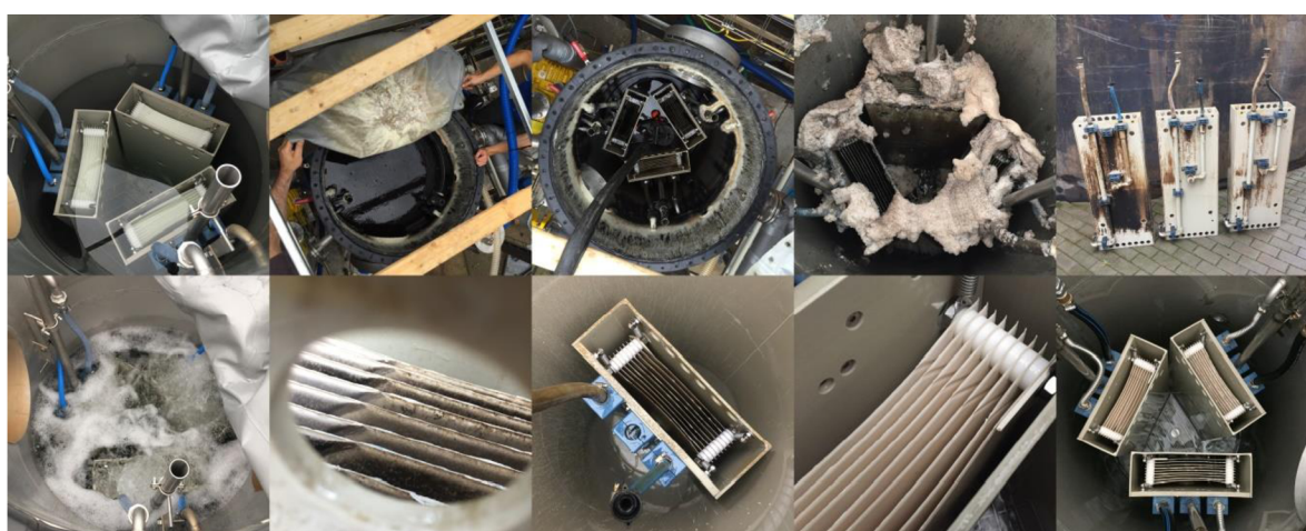
Obr. 37 Poloprovozní AnMBR - regenerace membránových modulů, mechanické i chemické čištění (foto autor)
