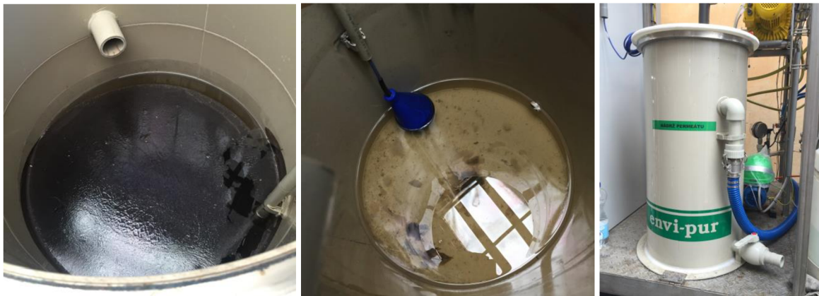
Obr. 28 Poloprovozní AnMBR - znečištění nádrže permeátu (foto autor)
