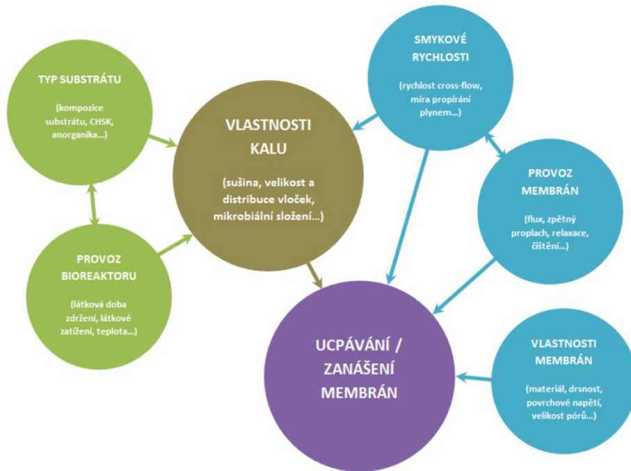
Obr. 4 Faktory ovlivňující ucpávání / zanášení membrán v AnMBR [43][54] (úprava autor)
