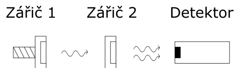
Obrázek 19: Schéma znázorňující stimulovanou emisi záření a jeho detekci.
