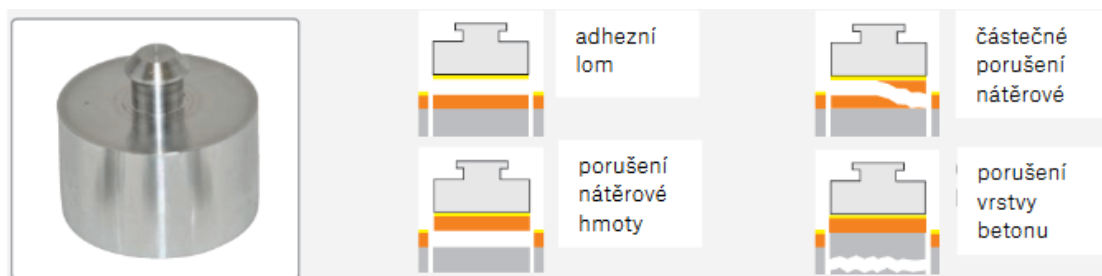
Obrázek 15: Terčik a možnosti porušení při odtrhové zkoušce přilnavosti [40]
