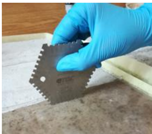
Obrázek 33: Měření tloušťky čerstvého nátěru pomocí šestihránného hřebene
