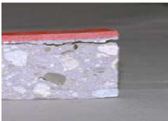
Obrázek 9: Použití nevhodného primeru [37]
