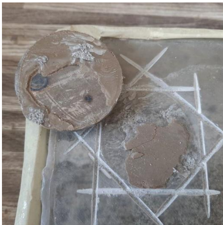
Obrázek 38: Porušení nátěru EP-S REF nátěr/lepidlo
