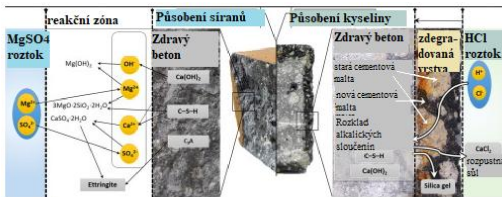
Obrázek 12: Mechanismus poškození povrchových vrstev betonu [24]
