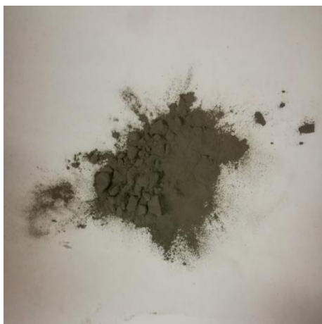
Obrázek 23: Vysokoteplotní popílek pocházející z tepelné elektrárny Opatovice
