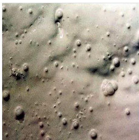
Obrázek 6: Ukázka nežádoucích bublin v nátěru [42]
