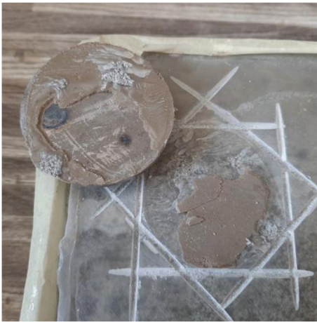
Obrázek 38: Porušení nátěru EP-S REF nátěr/lepidlo
