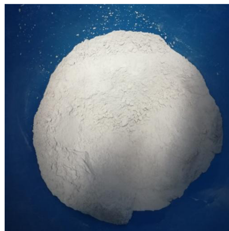
Obrázek 25: Odpadní obalové sklo pomleté pod velikost 63 μm
