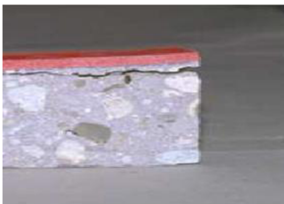
Obrázek 9: Použití nevhodného primeru [37]
