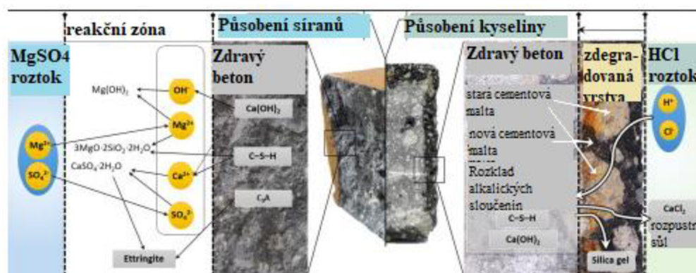
Obrázek 12: Mechanismus poškození povrchových vrstev betonu [24]
