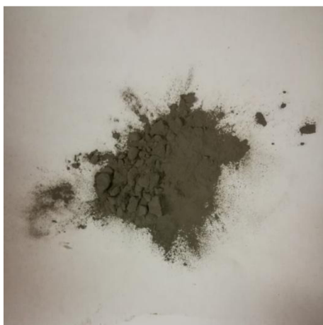
Obrázek 23: Vysokoteplotní popílek pocházející z tepelné elektrárny Opatovice
