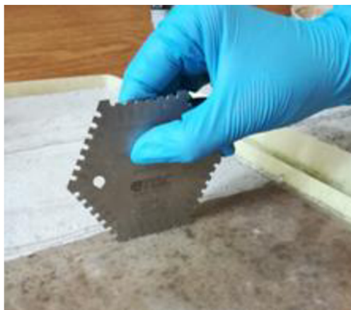
Obrázek 33: Měření tloušťky čerstvého nátěru pomocí šestihránného hřebene
