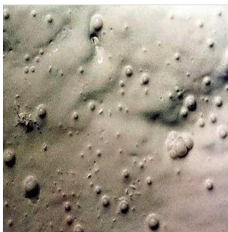
Obrázek 6: Ukázka nežádoucích bublin v nátěru [42]
