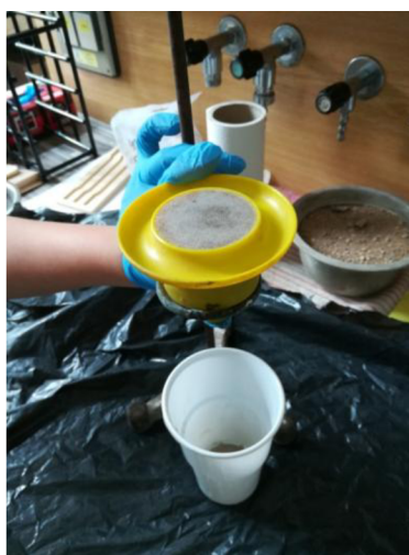
Obrázek 32: Fordův výtokový kelímek s výtokovým otvorem Ø12 mm naplněný nátěrem EP-S REF
