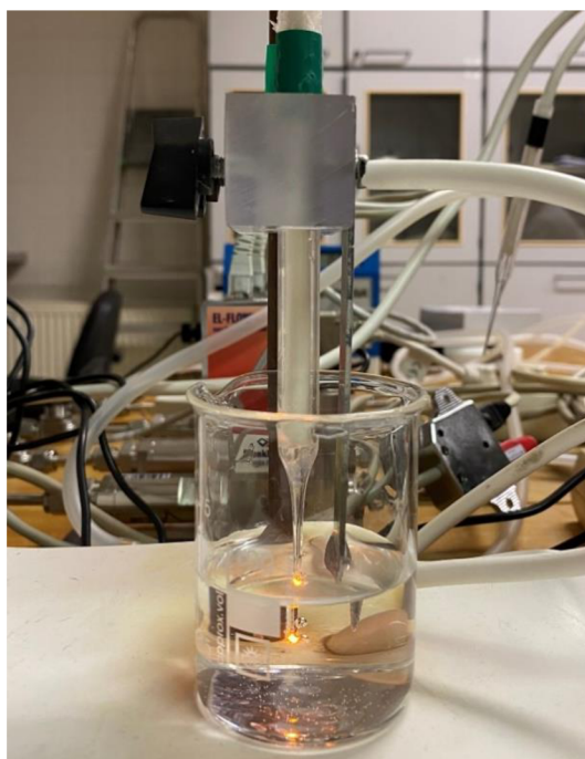
Obrázek 11: Příprava PAW plazmovou tryskou v kapalině se střídavým vysokofrekvenčním zdrojem napětí (AC).
