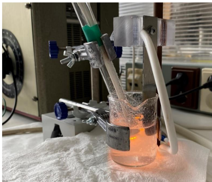
Obrázek 10: Příprava PAW plazmovou tryskou v kapalině se stejnosměrným zdrojem napětí (DC).
