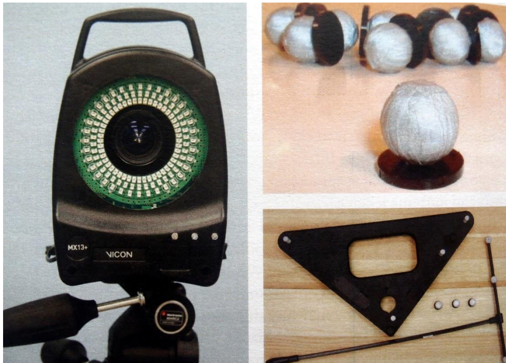
Obrázek 26 Kamera Vicon MX10, reflexní značky pro označení bodů a kalibrační zařízení (Janura et al., 2012)
