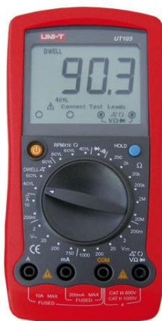
Obrázek 1.3: Víceúčelový multimetr UNI-T UT 105 (DSTechnik, 2022)
