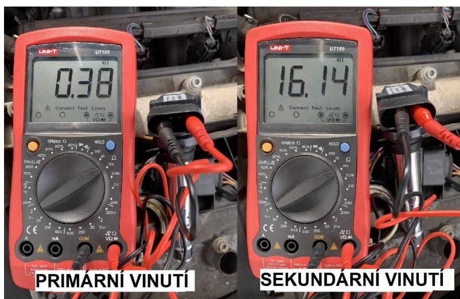
Obrázek 4.2: Výsledky kontroly zapalovacích cívek
