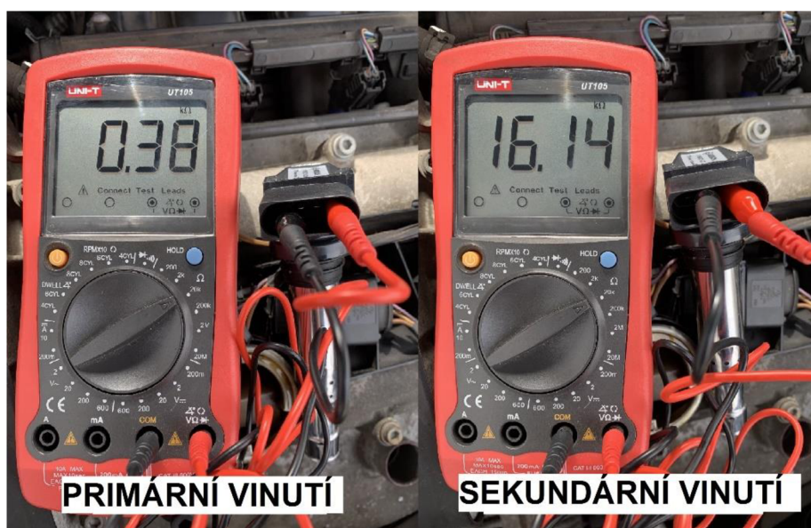
Obrázek 4.2: Výsledky kontroly zapalovacích cívek
