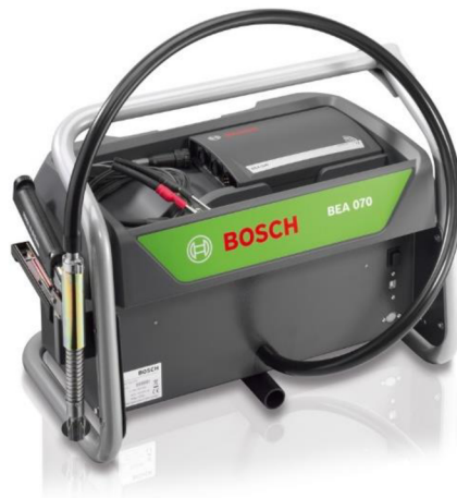
Obrázek 1.8: Opacimetr BOSCH BEA 070 (Bosch, 2021)
