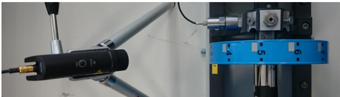
Obrázok 22 – Laboratórny prípravok pre meranie vibrácií na ÚAMT. Tacho sonda (vľavo) mieri svetelným lúčom na disk zotrvačníku ktorý je poháňaný elektromotorom (vpravo). Disk má na približne rovnakých uhlových intervaloch po 30 stupňoch rozmiestnené reflexné značky. Značka na indexe 1 chýba, teda celkovo je aplikovaných 11 značiek.
