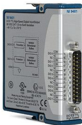
Obrázok 9 – Štandardné prevedenie modulov série C od National Instruments. Zobrazený je modul NI 9401 – vstupno-výstupný modul.
