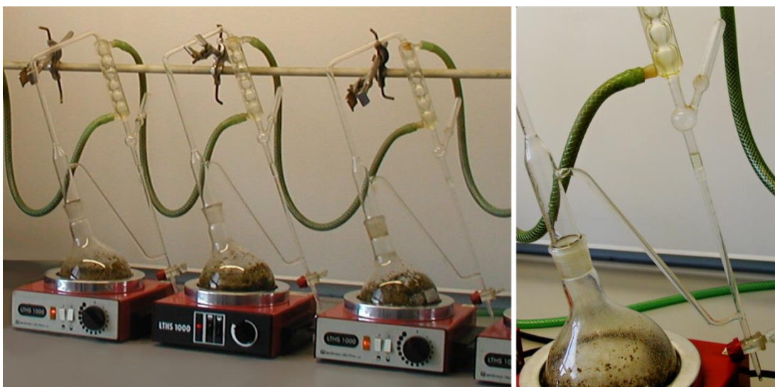
Obr. 13: Sada destilačních aparatur s detailním pohledem na dělenou trubici se silicí.
