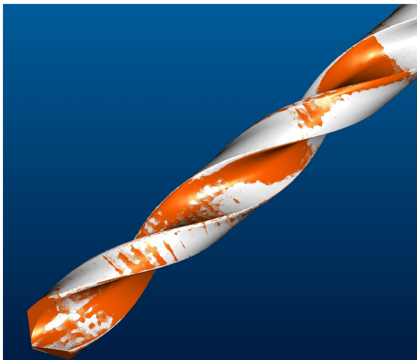
Obr. 4.25 Proložení skenu hladkým modelem
