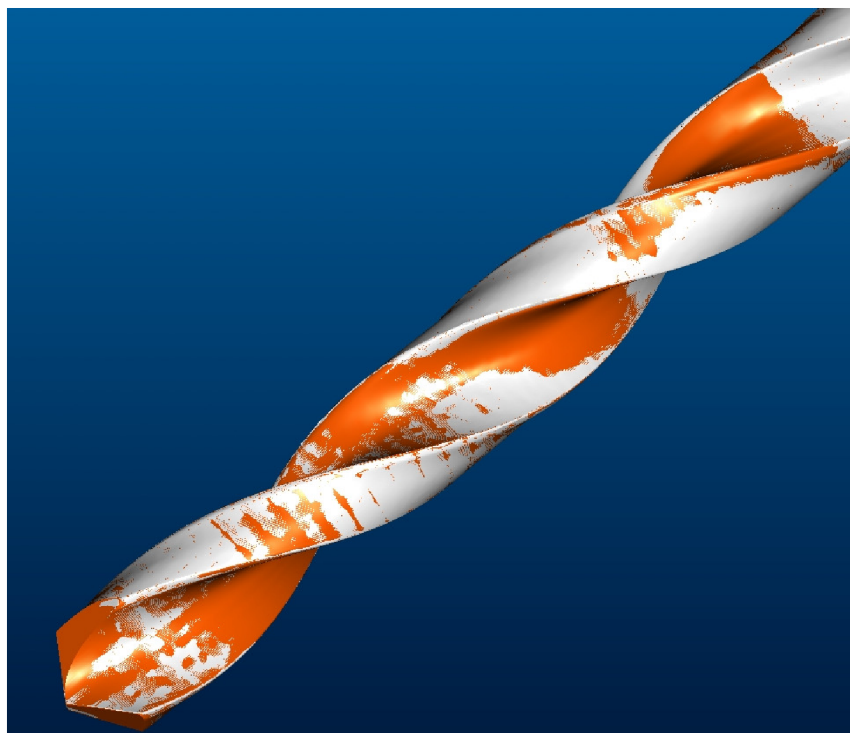
Obr. 4.25 Proložení skenu hladkým modelem
