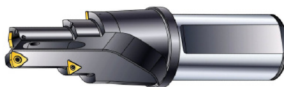
Obr. 1.12 Sdružený nástroj pro vrtání a dvojité zahlubování [3]
