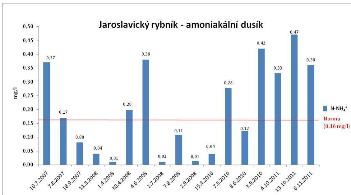
Graf 5: Naměřené hodnoty amoniakálního dusíku na Jaroslavickém rybníku v letech 2007 - 2011 (vyjma roku 2009)
