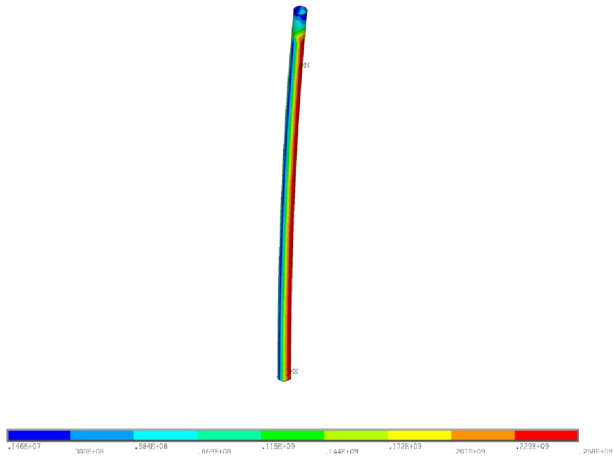
Obrázek 7.1 Vykreslení napětí podle Misesse , nejvíce namáhaný prvek stojina [Pa]
