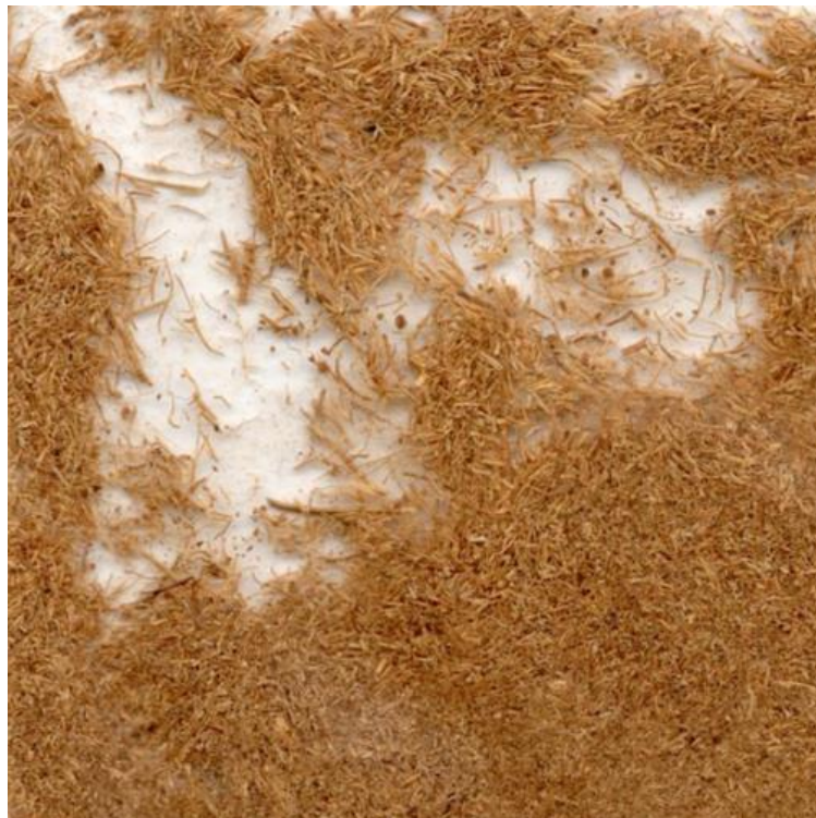
Obr. 15 Namletá kokosová vlákna (1,5 X)
