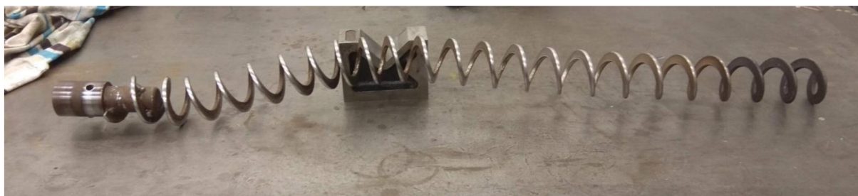
Obr. 7 Ohnutí šneku v podávací trubce při dávkování lesního odpadu
