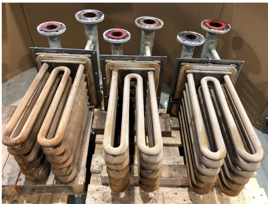
Obr. 16 Stav segmentů chladiče spalin po spalovacích zkouškách (směr proudění spalin byl zprava doleva)
