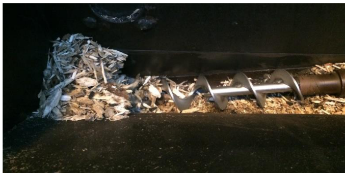
Obr. 8 Nový šnek s upravenou geometrií a délkou
