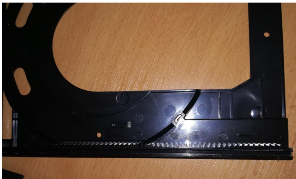
Obr. 12 Detail ozubeného hřebene na zásuvce pro disk mechanik LG.
