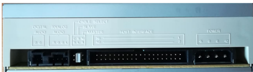
Obr. 8 Konektory na mechanice LiteOn iHAP122, zprava MOLEX, IDE, analogové audio, digitální audio. Mezi IDE a analogovým audio výstupem můžeme vidět přepínač režimů.
