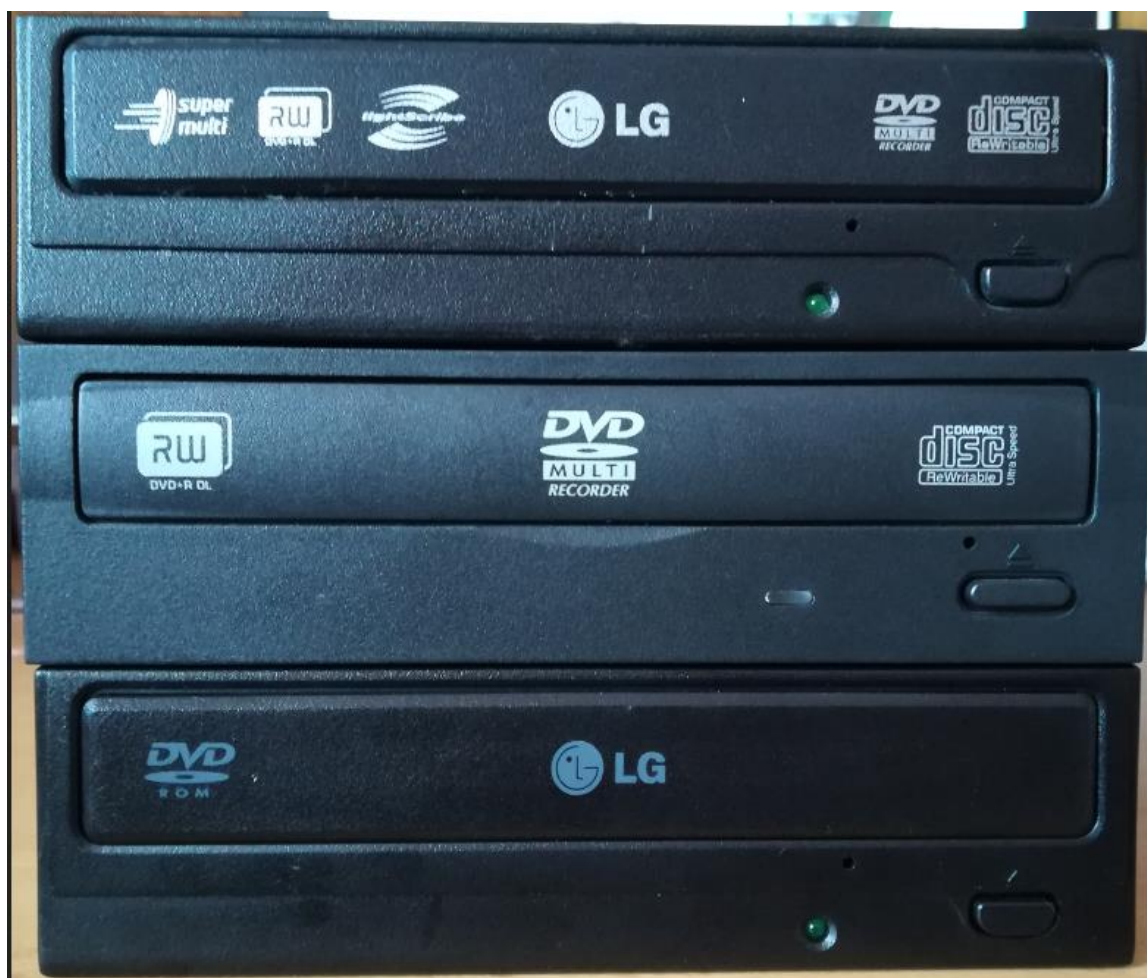
Obr. 6 Vybrané optické mechaniky, shora LG GSA-H12L, LiteOn iHAP122, LG GDR-8164B.
