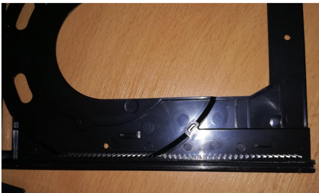
Obr. 12 Detail ozubeného hřebene na zásuvce pro disk mechaniky LG.
