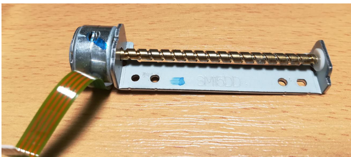
Obr. 17 Jednotka SM15DD starající se o pohon posuvu optiky u mechanik LG.
