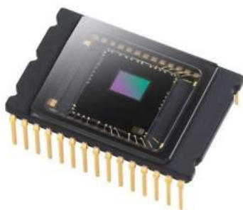
Obrázek 5- CMOS snímač (zdroj: http://mobilizujeme.cz/wp-content/uploads/2012/01/CMOS.jpg )
