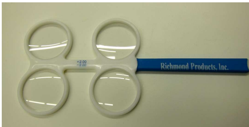
obr. 6. : vyšetření akomodační schopnosti za pomoci flipru o hodnotách +2,00 D a -2,00 D
