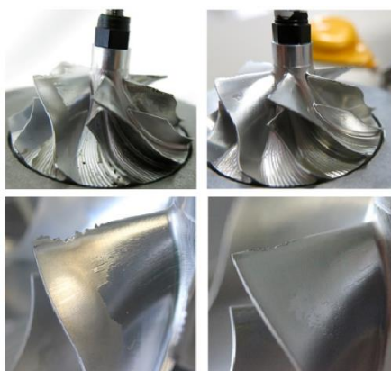
Obr. 55: Poškození lopatek kompresorového kola kapičkami vody [34]
