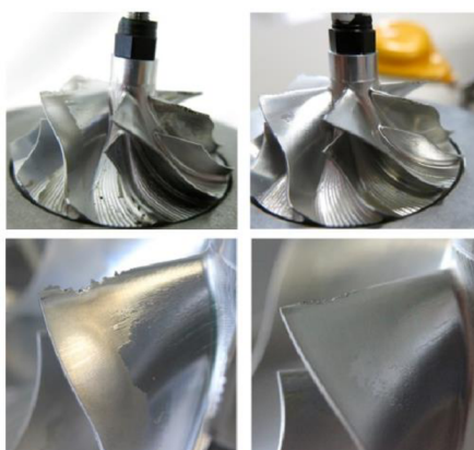
Obr. 55: Poškození lopatek kompresorového kola kapičkami vody [34]
