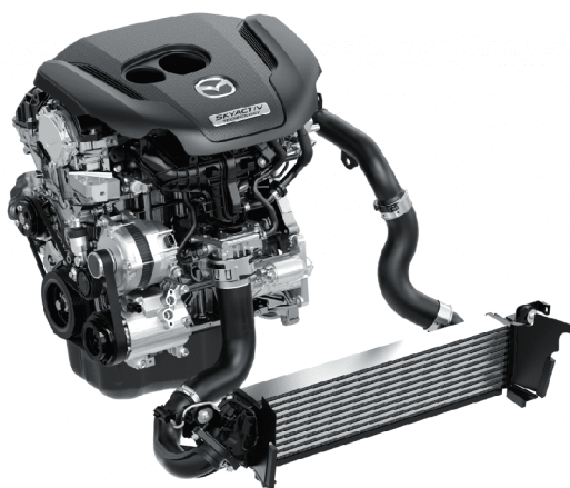
Obr. 17: Přepřňovaný zážehový motor Mazda se systémem EGR [12]
