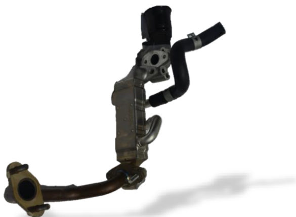
Obr. 13: EGR větev z motoru Honda 1.5 l
