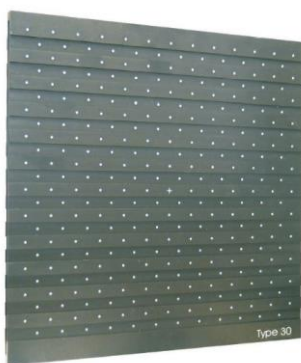
Obr. 19. Dvojúrovňový kalibrační terč [12]
