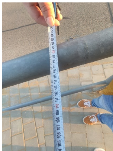
Obr. 97 Průchozí šířka u zábradlí
