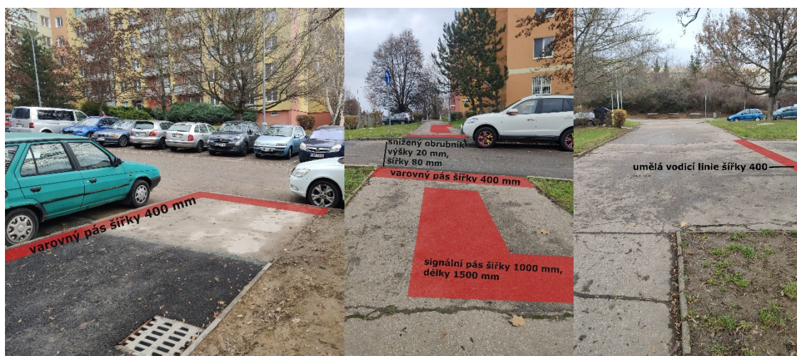
Obr. 158 Návrh doplnění varovného pásu u parkoviště
