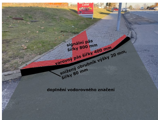
Obr. 259 Návrh úpravy přechodu před čerpací stanice (pohled 2)
