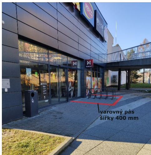
Obr. 154 Návrh varovného pásu okolo stojanu na kola
