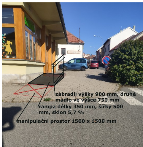
Obr. 79 Návrh přístupové rampy k mateřské škole
