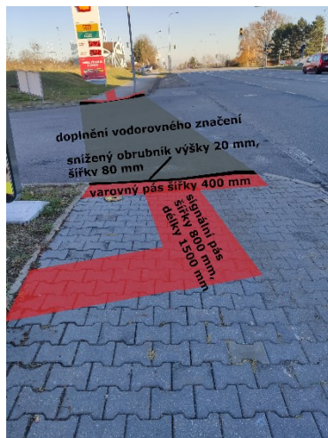
Obr. 260 Návrh úpravy přechodu před čerpací stanice (pohled 1)
