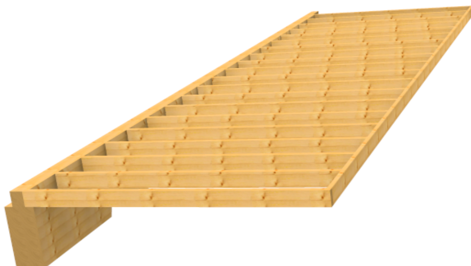
Obrázek 49 Rámy střešní konstrukce v lepeném nosníku
