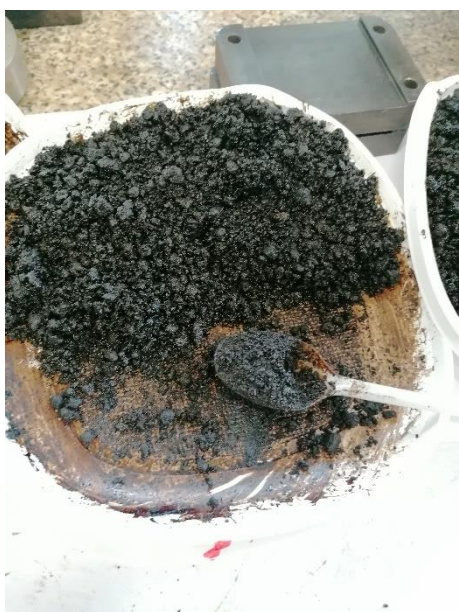
Obrázek 35: EMK z R-materiálu s 8 % asfaltové emulze
