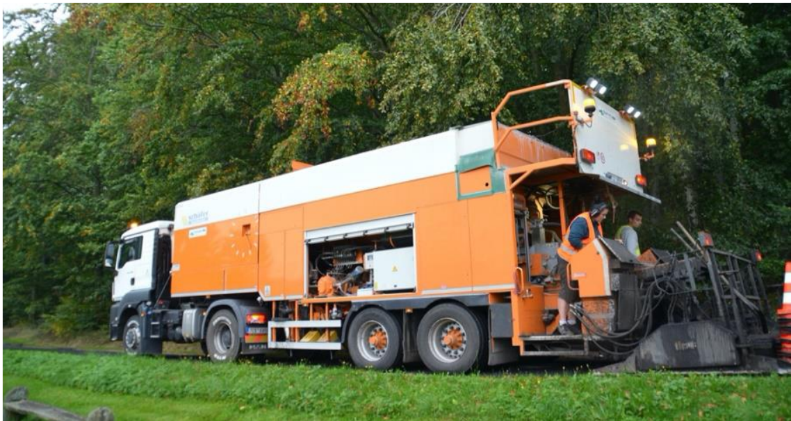
Obrázek 3: Souprava pro pokládku mikrokoberce společnosti Vialit Soběslav, zdroj: (13)
