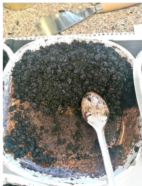
Obrázek 34: EMK z R-materiálu s 6 % asfaltové emulze
