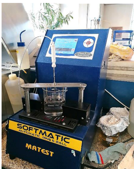
Obrázek 19: Zkušební zařízení pro kroužek a kuličku
