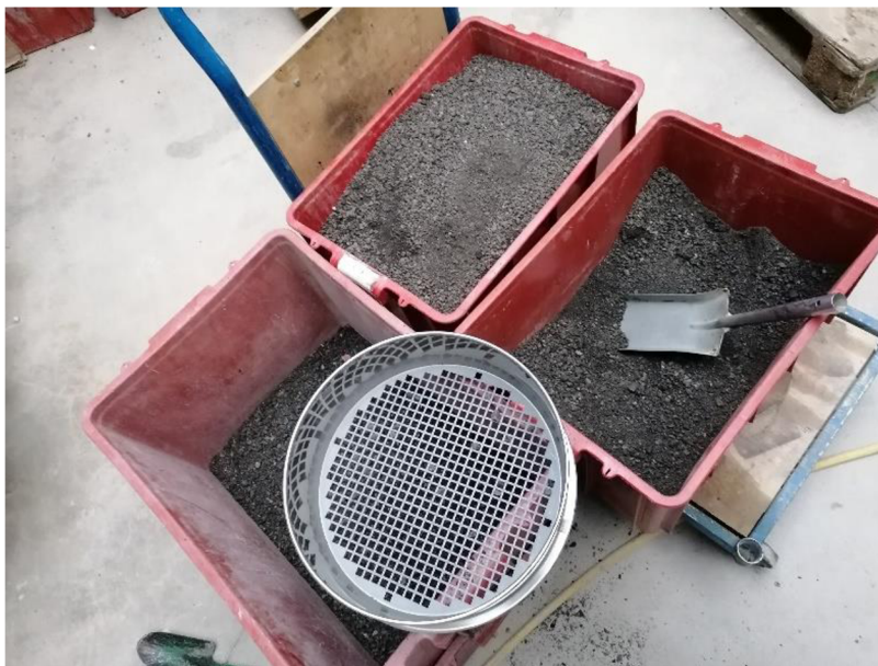
Obrázek 8: Získání požadované frakce R-materiálu pro EMK
