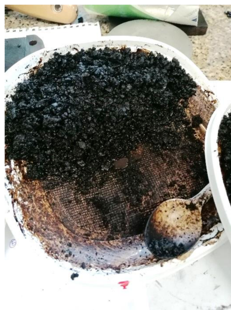
Obrázek 36: EMK z R-materiálu s 10 % asfaltové emulze
