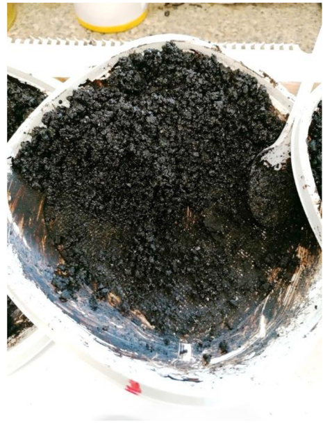
Obrázek 32: Reprezentativní vzorek EMK z přírodního kameniva
