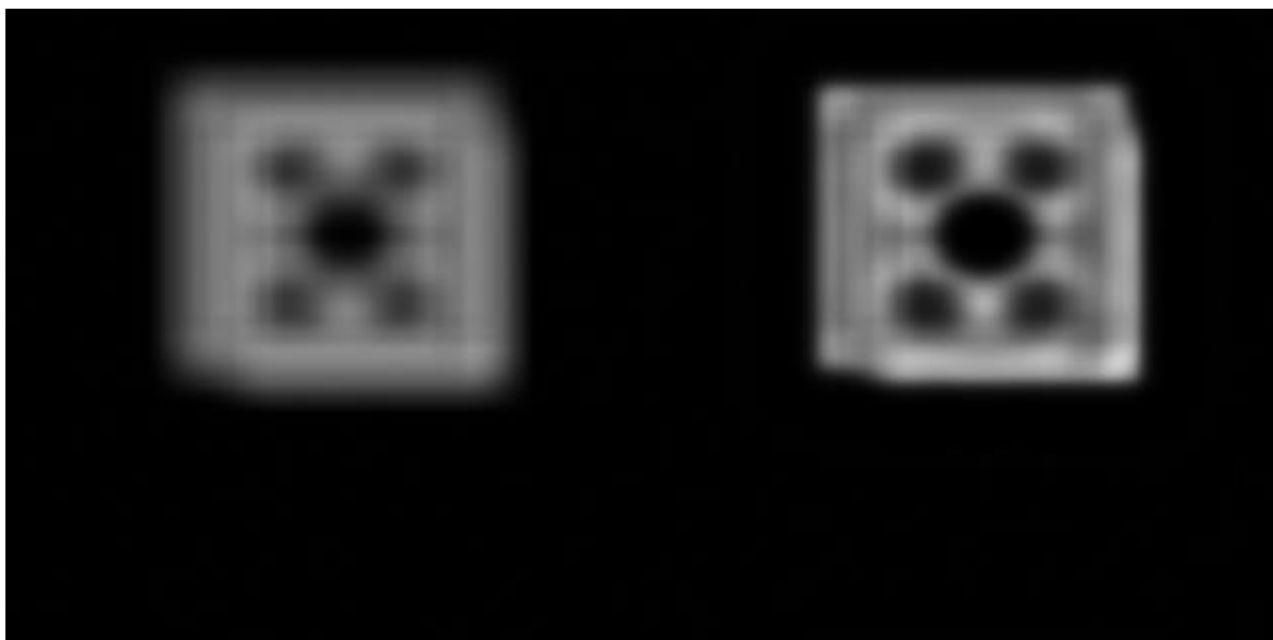
Obrázek 33 - Porovnání Lucy-Richardson dekonvoluce 320x320 obrazu na procesoru s typem Float [zdroj: autor]
