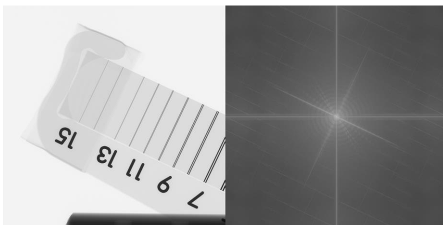
Obrázek 7 - příklad magnitudy na CT skenu dvoudrátkové měrky [zdroj: autor]
