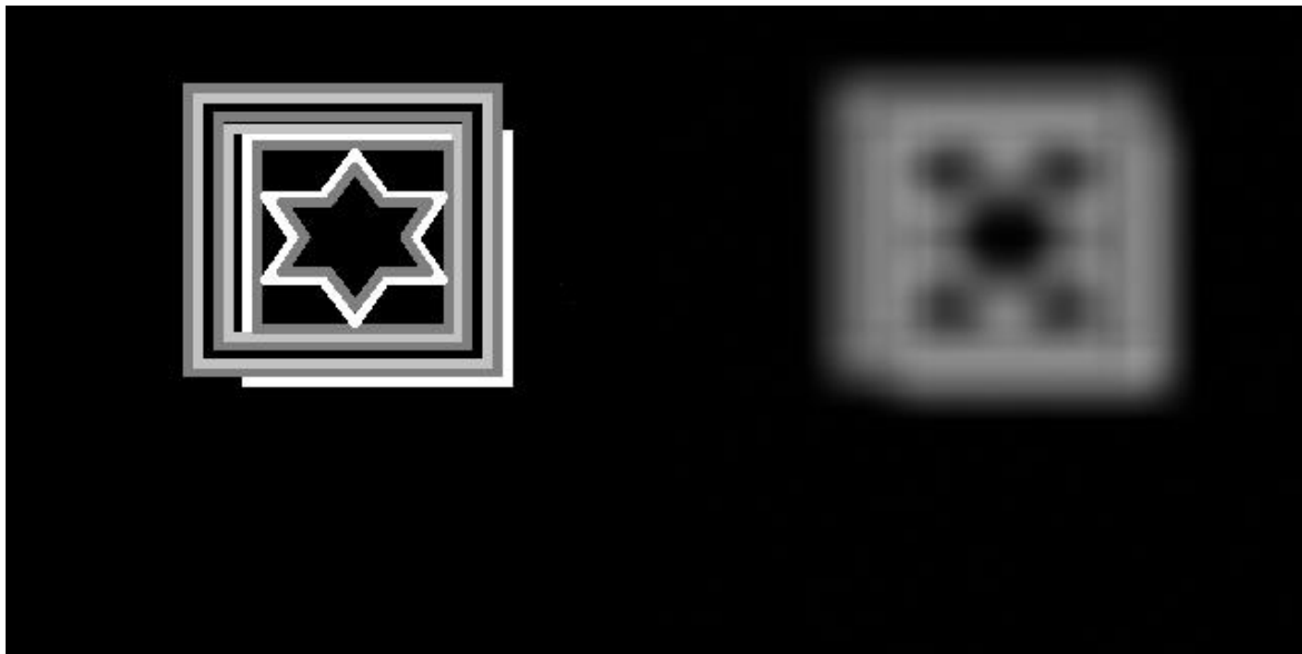
Obrázek 29 - Původní obraz s velikostí 320x320 a jeho konvoluce s gaussovským kernelem o velikosti 33x33 [zdroj: autor]
